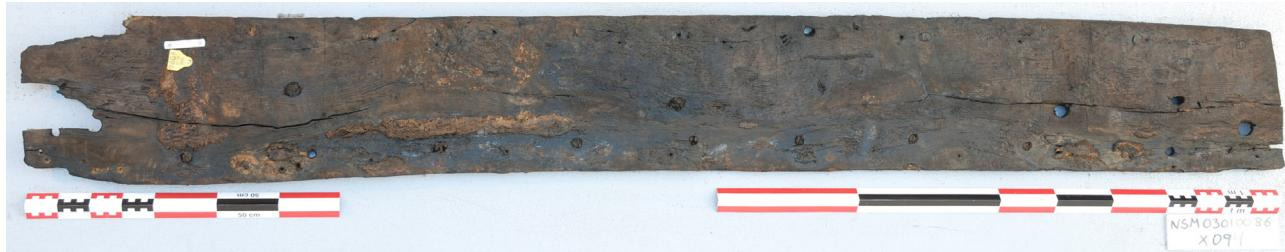
**Fig. 9:** Barcode 6'nın kaplamalarının içi, üç civiyle “klinker uygulanmış” olan alt kenar perçinli demir civilerle birleştiren kamalarla birlikte gösterilmektedir. Üst kenarda her şeyden önce perçinli demir civiler sonrasında delikler bulunmaktadır. Açık kahve rengi noktalar tekneyi korumuş olan ve su geçirmez zift tabakasının kalıntılarıdır. Foto: K. Steen/NMM.
