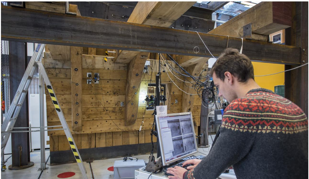
**Fig. 19:** Gerçek gemide bu tür testler yapılamadığı için geminin yan tarafındaki eklemlerin sertliğinin test edilmesi.
