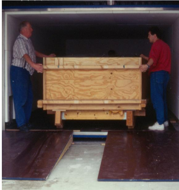
**Fig. 9:** Gemi 1'in 2. kısmına emdirilen melamin reçinesinin mikrodalga fırın içinde kürleşmesi. (Foto: RGZM)
