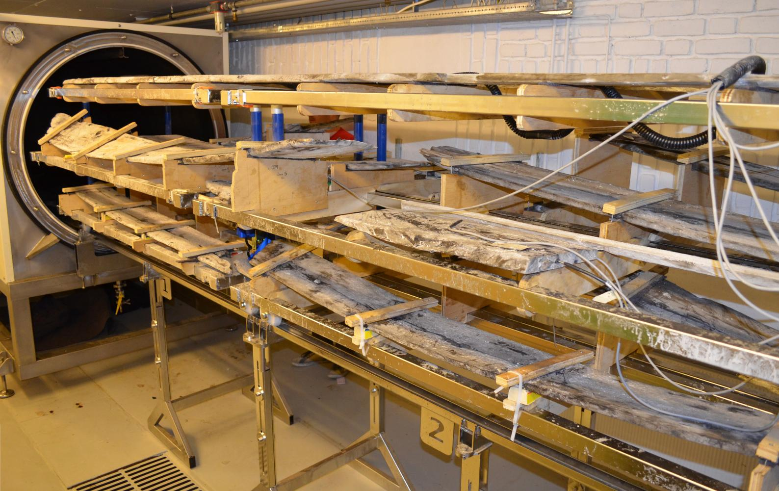
**Fig. 8:** Donduruculu kurutucuda altı ayını henüz tamamlayan Barcode 6 borda kaplamaları. Kaplamaların çoğu kontrplakten yapılmış olan kalıplara monte edilmiştir. Kalıplar tekninen dijital olarak ölçülen ölçekli maketine dayanarak şekillendirilmiştir, kaplamaların taşıtin kullanımında olduğu zamandaki orijinal şeklini göstermektedir. Fotoğrafta ayrıca iyi bir sirkülasyon sağlayan açık raf sistemi gösterilmektedir. Fazlalık olan beyaz PEG ısitma yoluyla temizlenecektir. Foto: NMM
