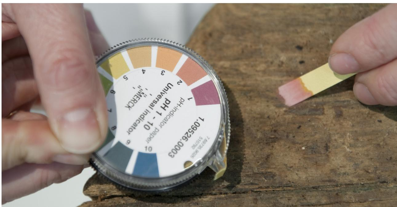
**Fig. 8:** Çam ağacından borda kaplama asitli ortama bir örnek oluşturuyor; pH indikatör kağıdında 1 ile 2 arasında pH görülmektedir.
