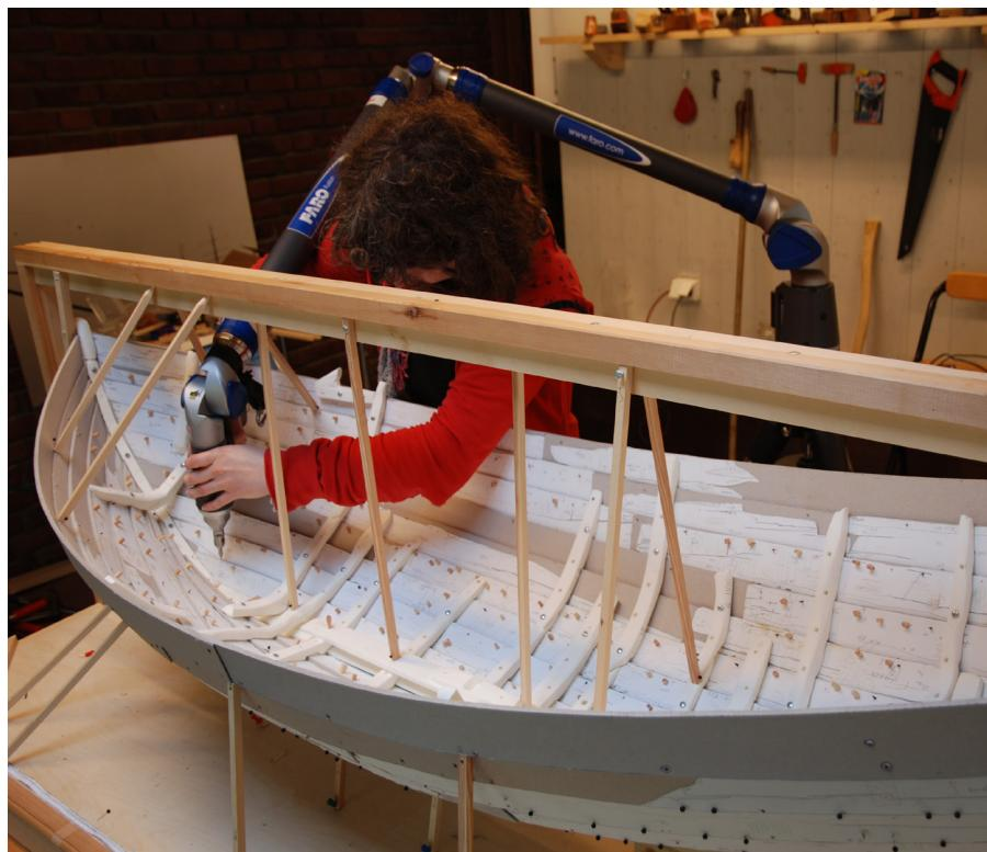
**Fig. 10:** Barcode 6'nın 1:5 ölçekli maketi arkeoloji personeliyle birlikte Lars Stålegård (tekne yapımı) ve Dr. Terje Planke tarafından yapılmıştır. Maket FARO-Arm ile kaydedilmiştir. Çizimler yapıyla dijital olarak çalışma olanağı sunmuştur ve ahşapların nasıl korunacağına karar vermede etkili olmuştur.
