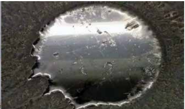
Fig. 3b: Sıvının yüzeyindeki PEG kristalleşmesi (S. Cohen).
