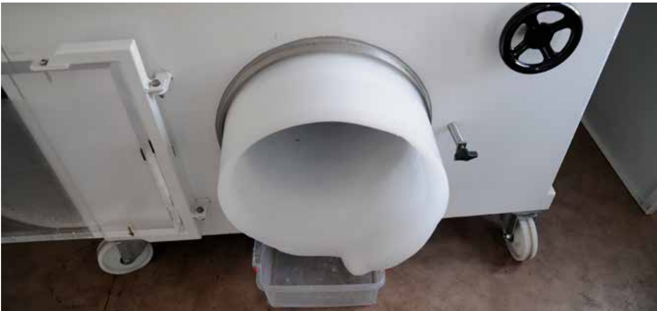
Fig. 31: Süblimleşme ile ahşap içerisinden kondansöre doğru buharlaşarak katılaşan su.
