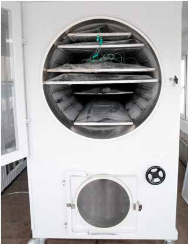
Fig. 28: Yenikapı Batıkları Projesinde kullanılan D9/25 model vakumlu dondurarak kurutma cihazı. Fig. 28: D9/25 model vacuum freeze dryer used in the Yenikapı Shipwrecks Project.
