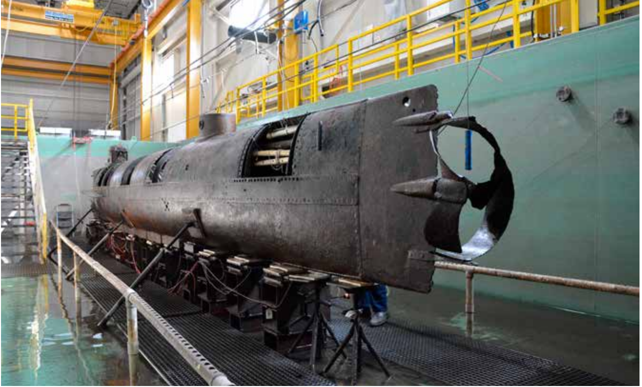
Fig. 15: Fig. 15: Depozitlerin arındırılması sonrasında kıçtan baş yönünde bakarken denizaltının görüntüsü. ©Friends of the Hunley. Fig. 15: View of the submarine looking forward from the stern after deconcretion. ©Friends of the Hunley
