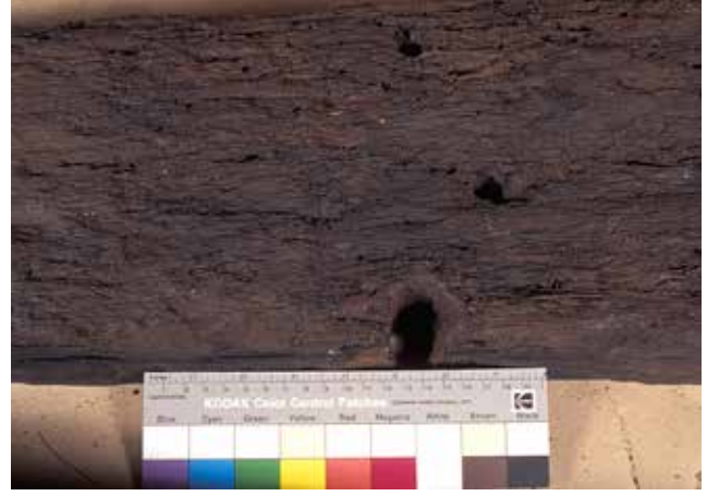
Fig. 21: PVP ile sağlamlaştırmadan sonra asitten arındırılmış Batavia ahşabı (F0).
