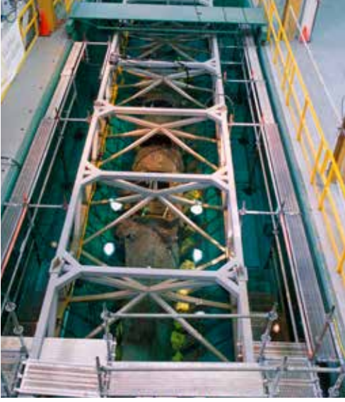
Fig. 3: Denizaltı konservasyon havuzunda. İskelet denizaltıyı bulunduğu şekilde 45 derece açıda tutmuş, kazı ve rotasyon süreçlerinde stabil bir destek sağlamıştır. ©Friends of the Hunley. Fig. 3: Submarine in its conservation tank. The truss kept the submarine's at at 45 degree angle as it was found, and provided a stable support during the excavation and rotation processes. ©Friends of the Hunley .
