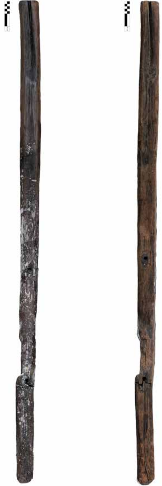
Fig. 32: PEG ön emdirme-vakumlu dondurarak kurutma öncesi (üst) ve sonrası (alt) ahşap.
