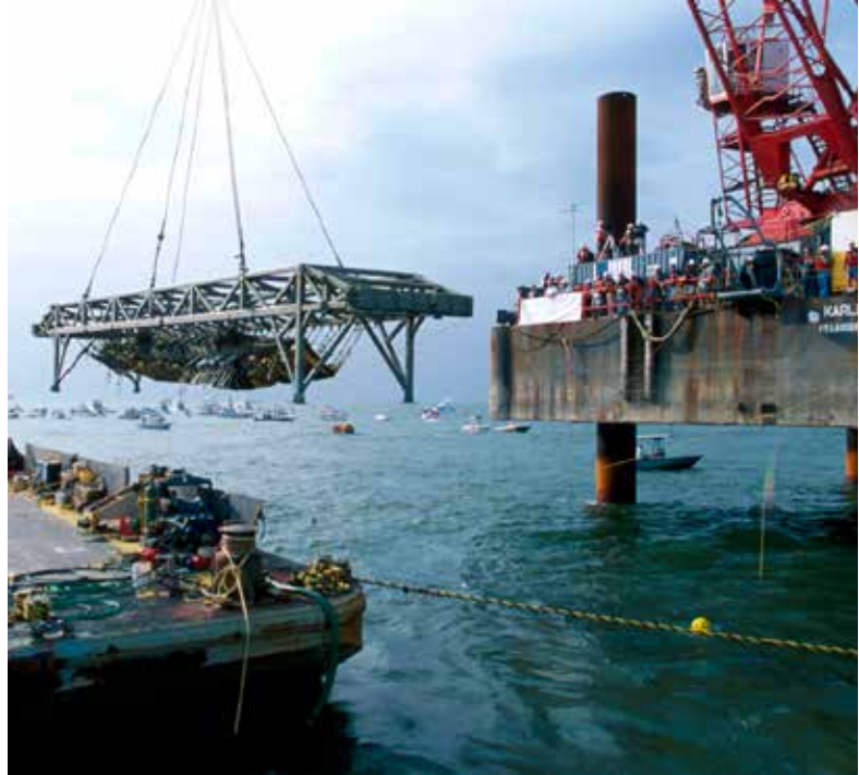
Fig. 2: Hunley denizaltısı destek iskeleti ile çıkarılırken. Hunley bir mavnaya yerleştirilerek nehir taşımacılığı yoluyla Warren Lasch Konservasyon Merkezine götürülmüştür. ©Friends of the Hunley.
