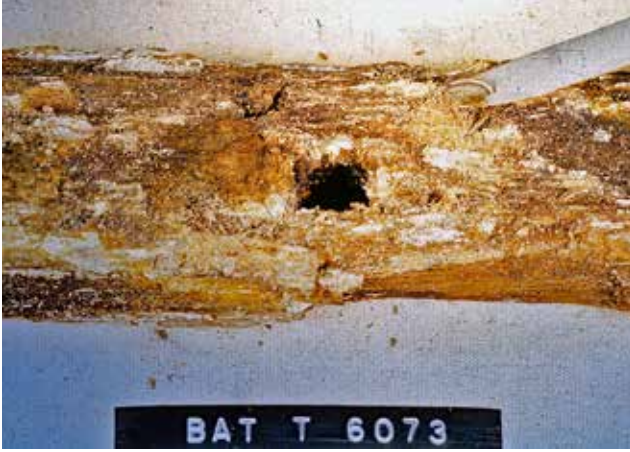
Fig. 17: Asitten arındırma öncesinde asitten etkilenmiş ahşap. Fig. 17: Acid-affected timber before deacidification.
