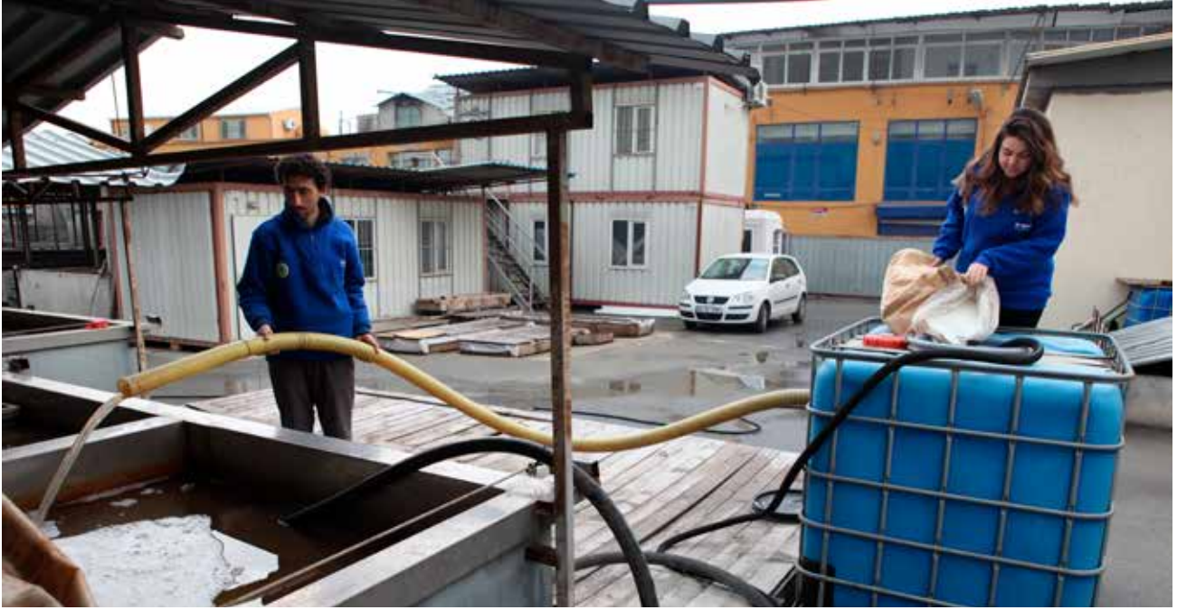
Fig. 25: Devir daim tankı ile PEG emdirme işlemi.
