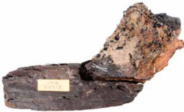
Fig. 22: Yenikapı 16 numaralı batık ahşaplarında demir korozyonu.
