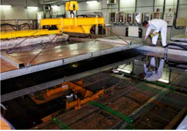
Fig. 14: PEG emdirmе havuzları. (MDAA © Rémi Bénali)
