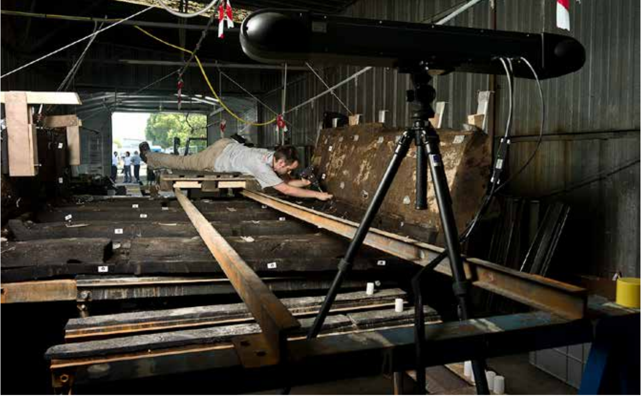
Fig. 10: C-Track görüntüleme aracı kullanılarak AR3 batığının bir bölümünün üç boyutlu kaydı. (MDAA / O'Can-Ipso Facto © Teddy Seguin)
