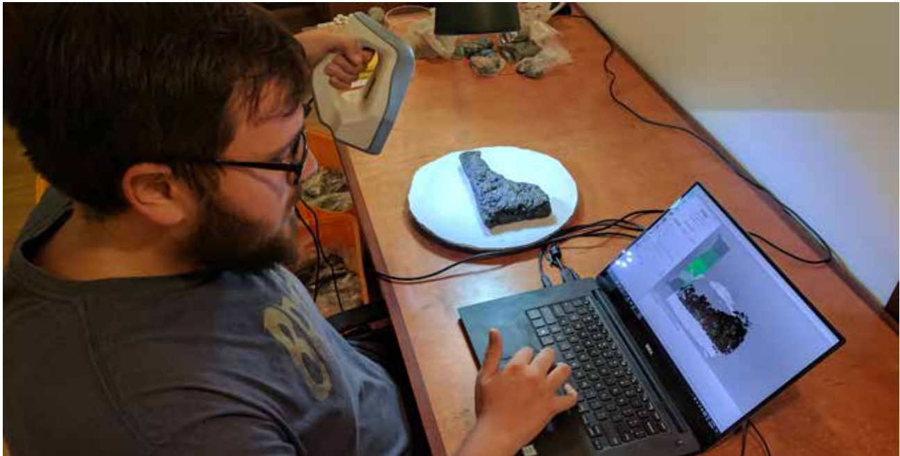
Fig. 3: Samuel Martin Temmuz 2017 tarihinde elde taşınır bir yapılandırılmış ışık tarayıcı kullanarak bir öküzgönü külçe çeyreğinin 3D modelini oluştururken (Foto: J.W. Lehner).
