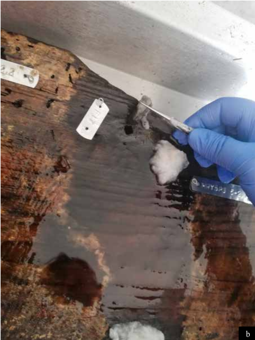
Fig. 9: %5'lik EDTA çözeltisi ile çivi deliklerinin temizlenmesi © INA.
