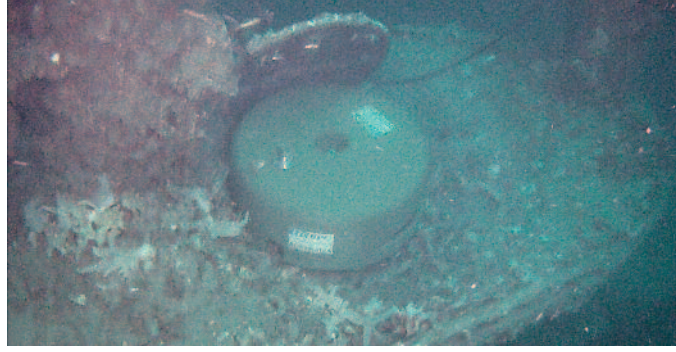
Fig. 13: Gövde içerisinden çevresel su akışını muhafaza ederken aynı zamanda AE2 'yi kapatarak içini koruma amacına uygun tasarlanmış olan 'Üst Kapak'.
