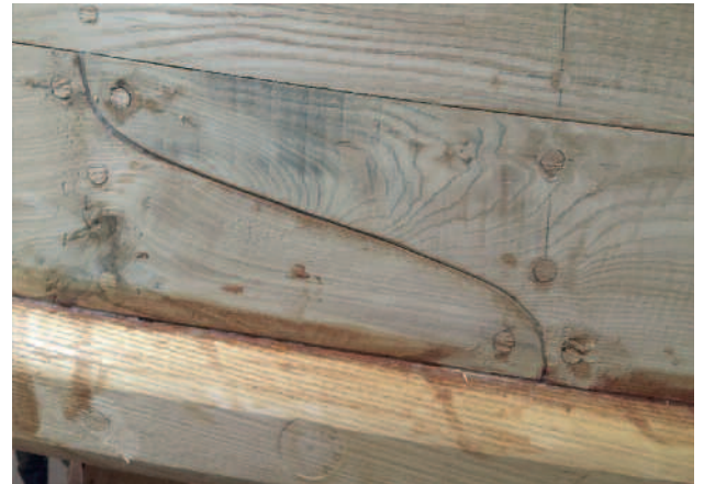
Fig. 21: Kaplamada "S" biçimli parile ve çivi delikleri. Fig. 21: "S" shaped scarphs and nail holes on strake.
