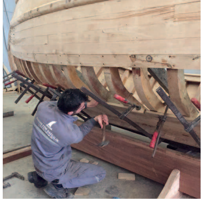
Fig. 25: Dı kaplamaların kurulumu. Fig. 25: Installation of exterior planking.
