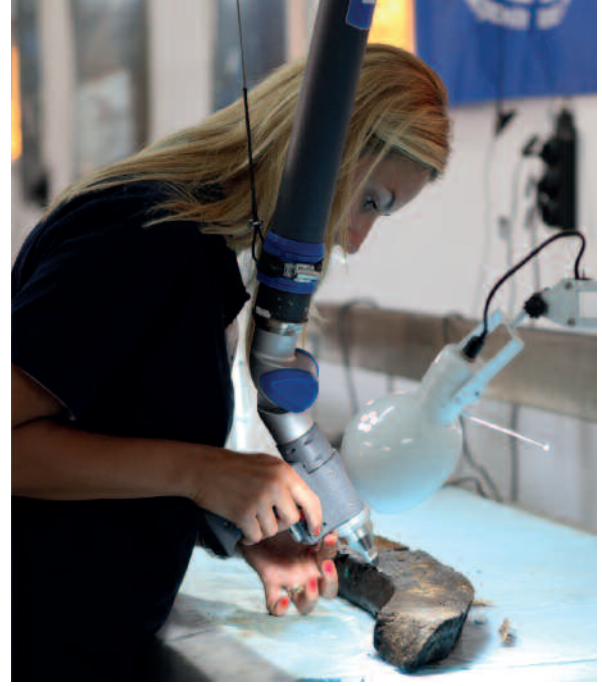
Fig. 4: Gemi parçalarının yapım tekniği ve rekonstrüksiyon için 3B çizimlerinin yapılması.
