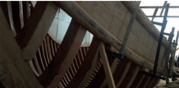
Fig. 24: apa tahtasının yerletirilmesi. Fig. 24: Installaton of the wale.
