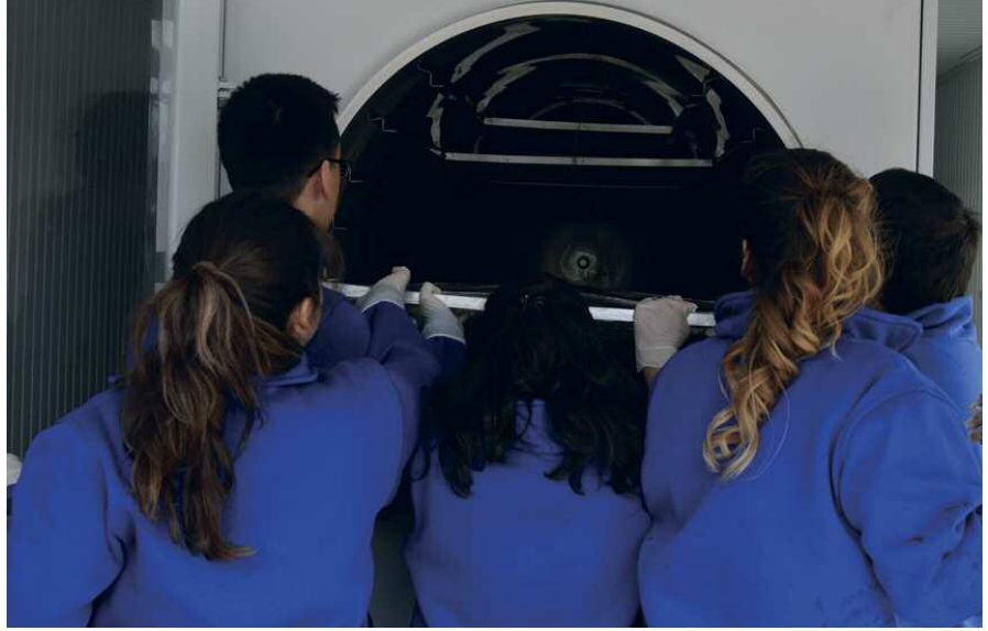
Fig. 3: YK 1 ahşaplarının dondurarak kurutma cihazına yerleştirilmesi.
