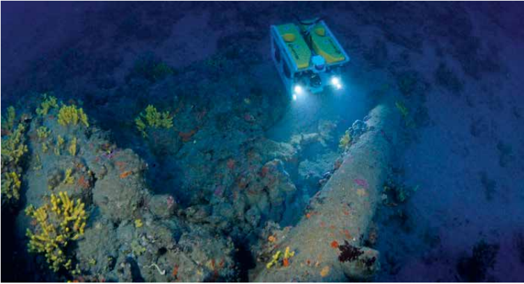
Fig. 4: Batığa ait top üzerinde görüntü alan uzaktan kumandalı sualtı robotu. (ROV)
