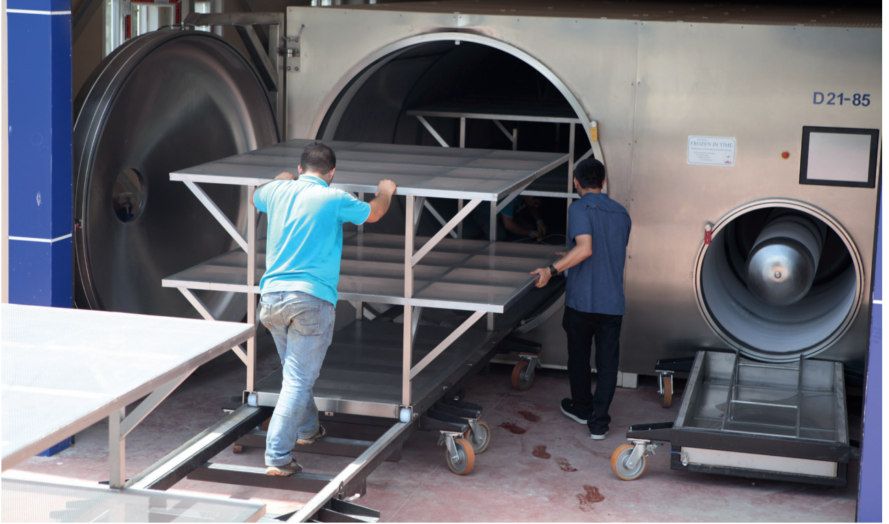
Suya doymuş ahşapların cihaza yerleştirilmesi. Placing the waterlogged wood into the device.
