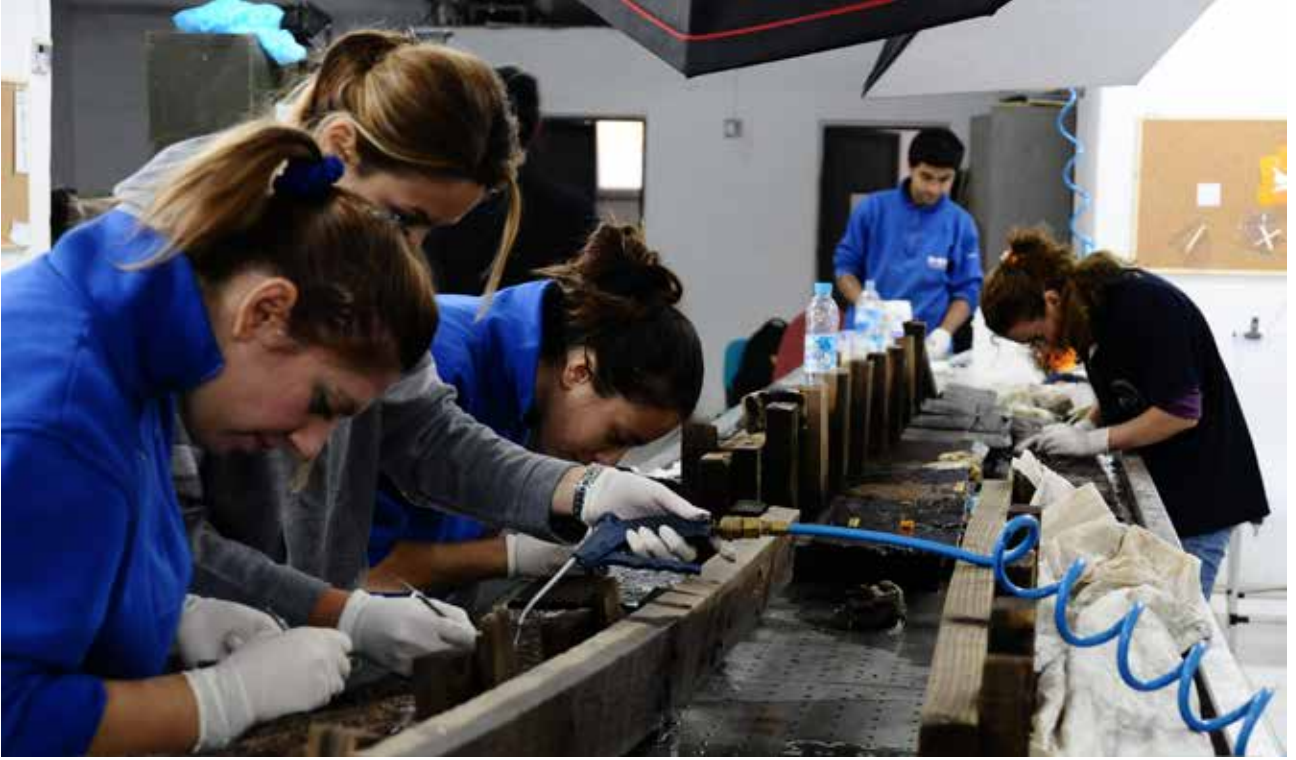
Fig 1b.: İstanbul Üniversitesi Yenikapı Batıkları Uygulama ve Araştırma Laboratuvarı'nda konservasyona hazırlanan suya doymuş nitelikteki batık elemanları. / Waterlogged shipwreck timbers prepared for conservation at Istanbul University Yenikapı Shipwrecks Application and Research Laboratory
