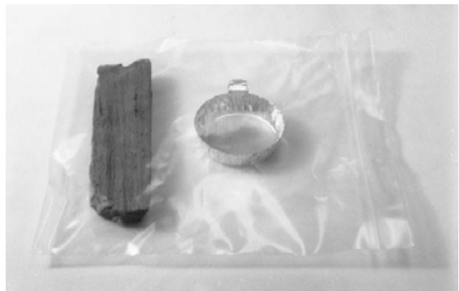
Fig. 3 Ahşap esere katalizör uygulanması, Smith 2003, 26
