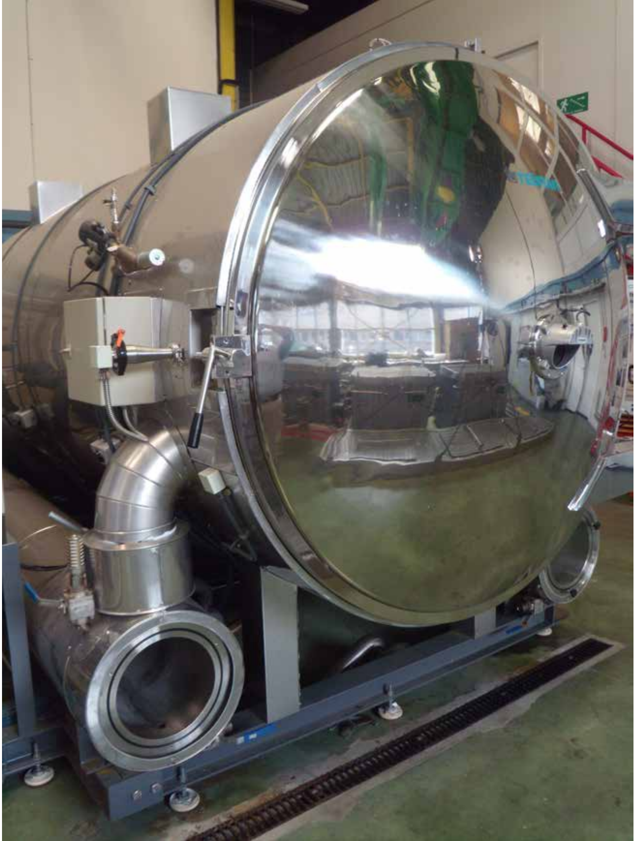
Fig 5: ARC-Nucléart laboratuvarındaki büyük boyutlu ahşap konservasyonu için kullanılan vakumlu dondurarak kurutucu, Grenoble/Fransa, 2011/ Vacuum freeze dryer for large-scale wood conservation in the ARC-Nucléart laboratory, Grenoble/France, 2011.
