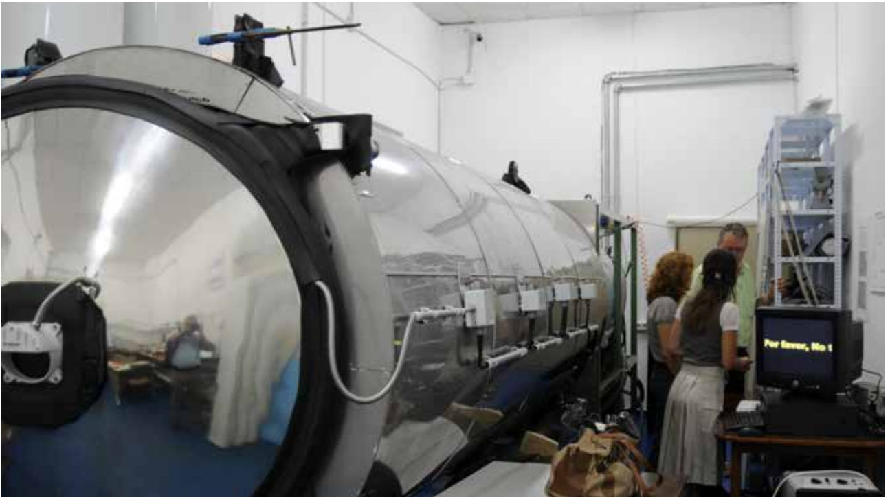
Fig 4: Mazarron I batığının ahşaplarının konservasyonunda kullanılan vakumlu dondurarak kurutucu, Cartagena/ İspanya, 2008. / Vacuum freeze dryer for the conservation of wood from the Mazarron I shipwreck, Cartagena/Spain, 2008.
