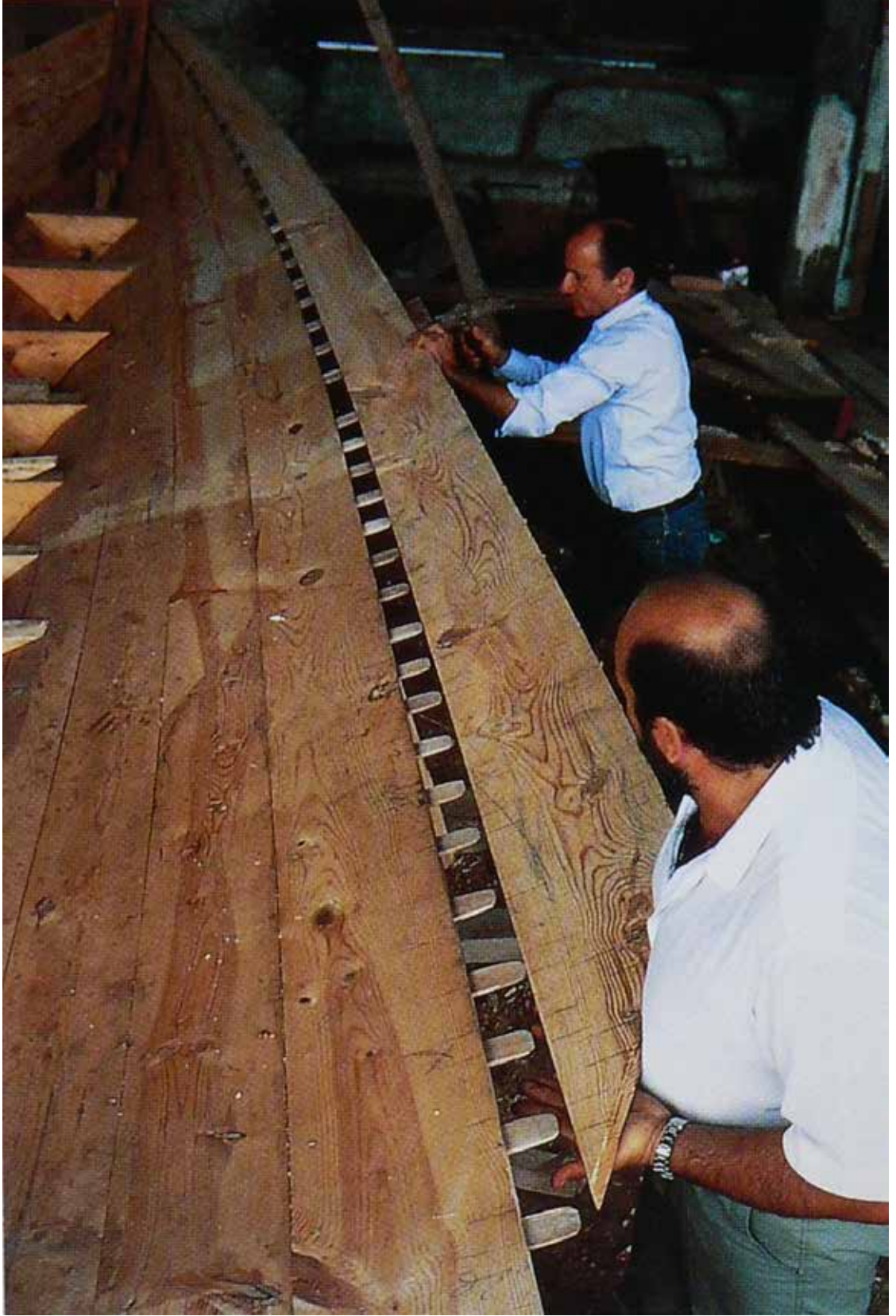
Fig. 5. Kyrenia Batığı replikasında uygulanan “Kabuk İlk” teknîği (Bass 2005, s. 78).
