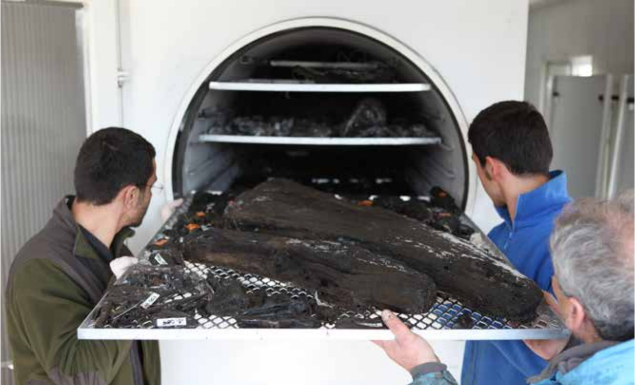
Fig 6: İstanbul Üniversitesi Yenikapı Batıkları Projesi kapsamında hizmete alınan 2,5 m boy, 0.90 m çapındaki vakumlu dondurarak kurutucu. / 2.5 m long, 0.90 m diameter vacuum freeze dryer, which was put into service within the scope of Istanbul University Yenikapı Shipwrecks Project.
