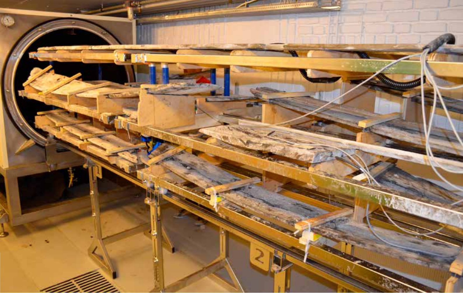
Fig. 8: Donduruculu kurutucuda altı ayını henüz tamamlayan Barcode 6 borda kaplamaları. Kaplamaların çoğu kontrplaktan yapılmış olan kalıplara monte edilmiştir. Kalıplar teknenin dijital olarak ölçülen ölçekli maketine dayanarak şekillendirilmiş olup, kaplamaların taşıtın kullanımda olduğu zamandaki orijinal şeklini göstermektedir. Fotoğrafta ayrıca iyi bir sirkülasyon sağlayan açık raf sistemi gösterilmektedir. Fazlalık olan beyaz PEG ısıtma yoluyla temizlenecektir. Foto: NMM
