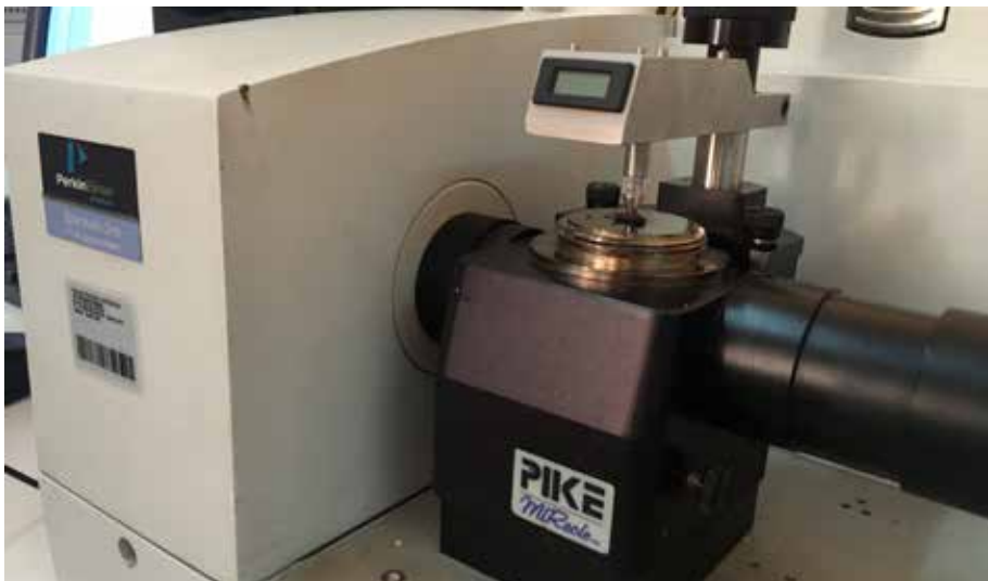
Fig. 1: Ahşabın analiz çalışmalarında yaygın olarak kullanılan ATR-FTIR cihazı.
