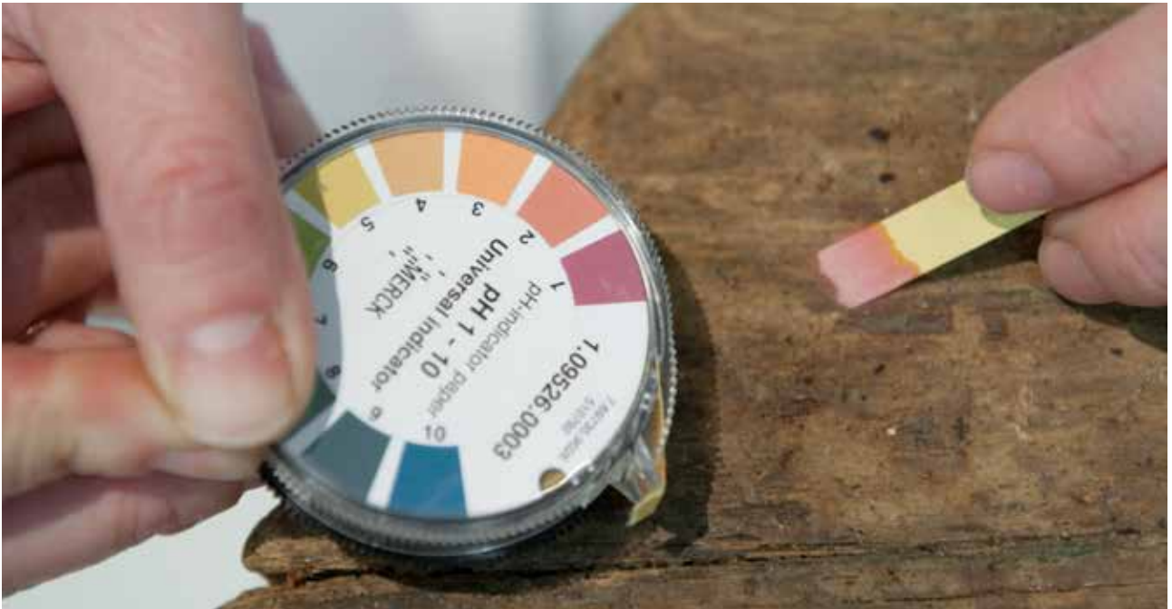
Fig. 8: Çam ağacından borda kaplama asitli ortama bir örnek oluşturuyor; pH indikatör kağıdında 1 ile 2 arasında pH görülüyor. Fig. 8: An example of the acidic conditions on this pine plank; the pH indicator paper reads a pH of between 1 and 2.
