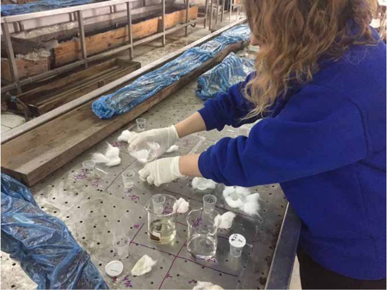
Fig. 4: Yenikapı Batıklarında kullanılmak üzere hazırlanan demir şelat çözeltileri.
