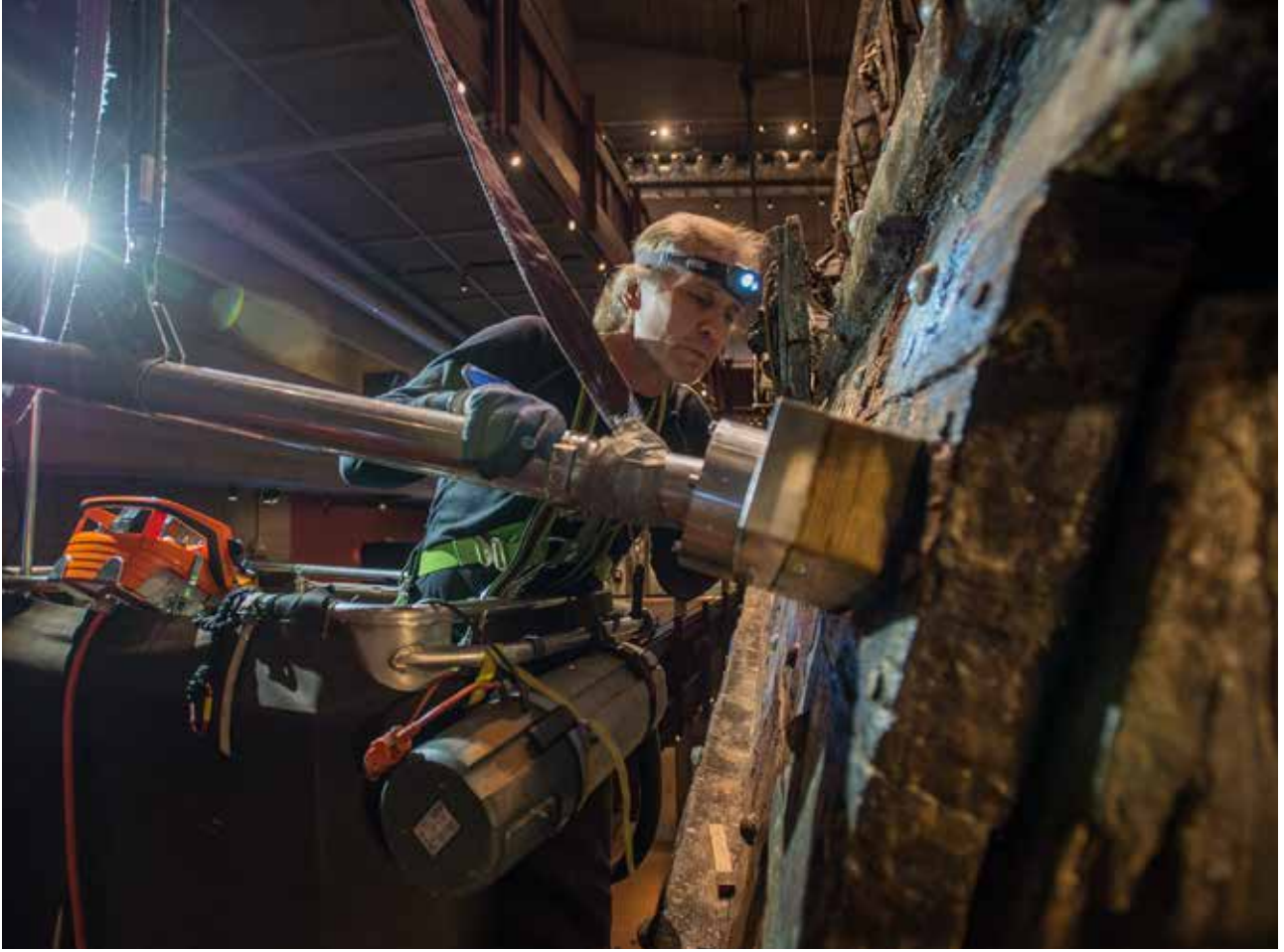
Fig. 16: Baş üstü vinçten asılmış özel bir sıkma aleti kullanarak cıvataların değiştirilmesi.
