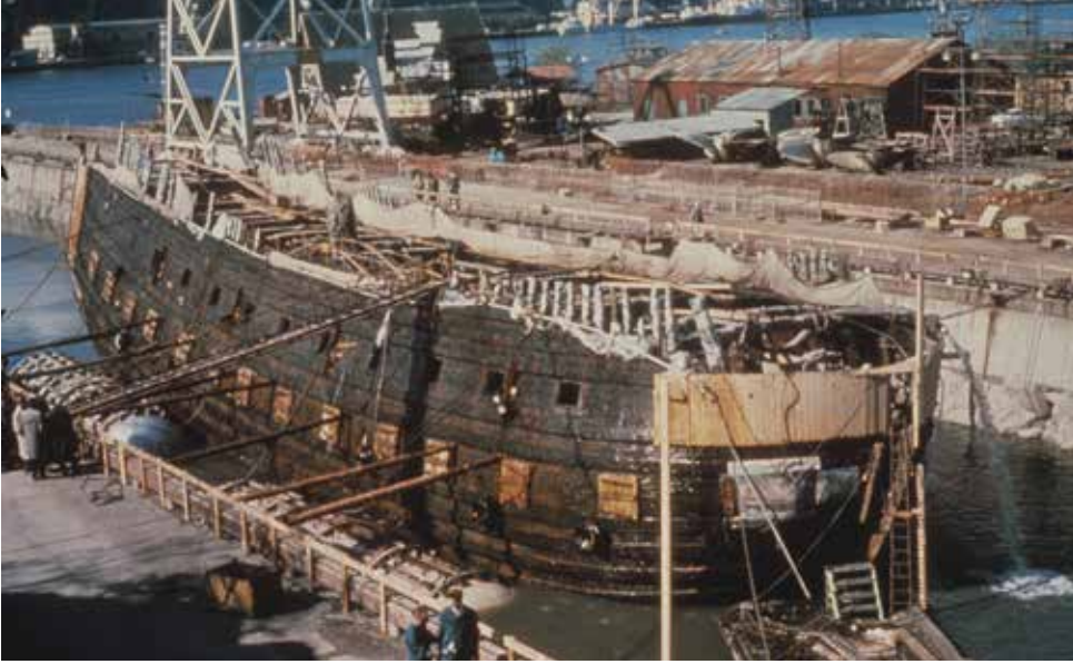
Fig. 2: Vasa kuru havuza alındıktan sonra ek yüzdürme araçlarıyla takviye ediliyor.
