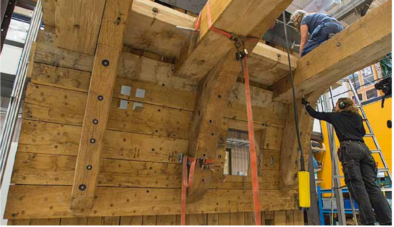
Fig. 18: Geminin bir yanının tam ölçekli inşası.
