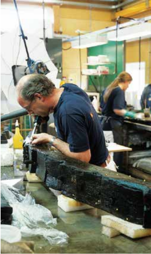
Fig. 5: Roskilde gemilerinin FaroArm cihazı ve 3D Rhino yazılımı kullanılarak dokümantasyonu. (Foto: Viking Gemi Müzesi-Roskilde)
