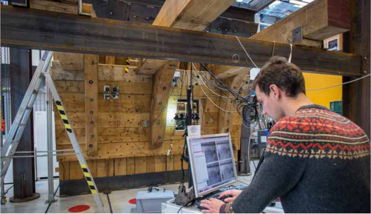
Fig. 19: Gerçek gemide bu tür testler yapılamadığı için geminin yan tarafındaki eklemlerin sertliğinin test edilmesi. Fig. 19: Testing the stiffness of the joints in the section of ship's side since such tests could not be done on the actual ship.
