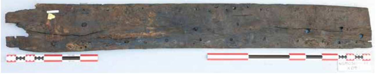
Fig. 9: Barcode 6'nın kaplamalarının içi, üç çiviyle "klinker uygulanmış" olan alt kenar perçinli demir çivilerle birleştiren kamalarla birlikte gösterilmektedir. Üst kenarda her şeyden önce perçinli demir çiviler sonrasında delikler bulunmaktadır. Açık kahve rengi noktalar tekneyi korumuş olan ve su geçirmez zift tabakasının kalıntılarıdır. Foto: K. Steen/NMM.
