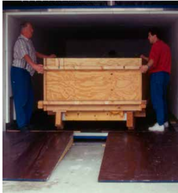
Fig. 9: Gemi 1'in 2. kısmına emdirilen melamin reçinesinin mikrodalga fırın içinde kürleşmesi. (Foto: RGZM)
