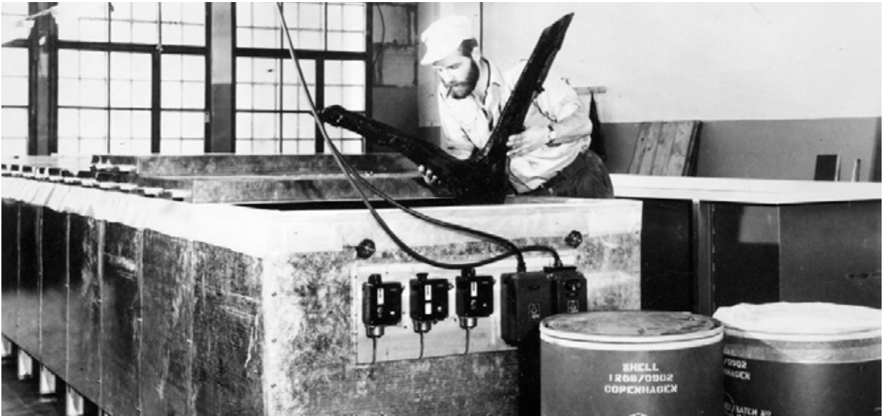
Fig. 7: Skuldelev gemilerinden birindeki kaburgalardan biri emdirmeye tankına yerleştiriliyor. Kırk yıl sonra Roskilde gemileri de aynı ortamlarda emdirilirken, emdirmeye sırasında artık ısıtıcı kullanılmadığından orijinal tanklardan bazıları değiştirildi (fotoğraf: Roskilde'de bulunan Viking Gemisi Müzesi).
