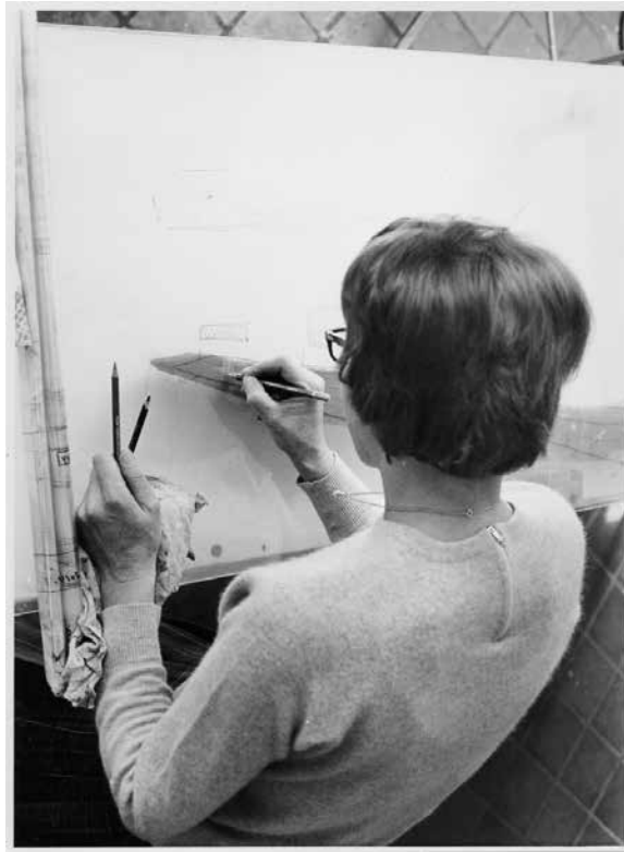
Fig. 4: Skuldelev gemilerinin dokümantasyonu. Eğrilerin 1:1 ölçeğinde çizimi polyester folyo üzerine renkli kalemlerle yapılmıştır. (Foto: Viking Gemi Müzesi-Roskilde)
