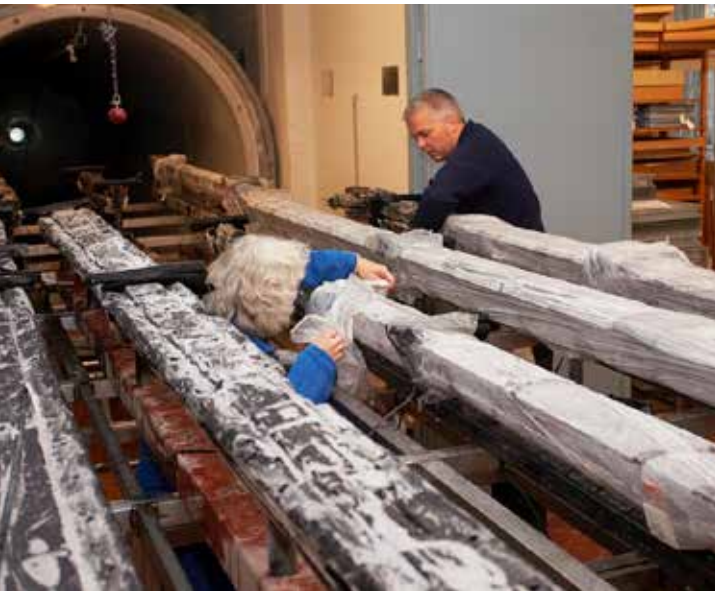
Fig. 9: Roskilde 6 omurgasının dondurarak-kurutucu için hazırlanışı. 32 m uzunluğundaki omurganın parçaları vakumlu dondurucuya itilmeden önce düzenlenerek kızağa sabitleniyor. (Foto: Viking Gemi Müzesi-Roskilde)
