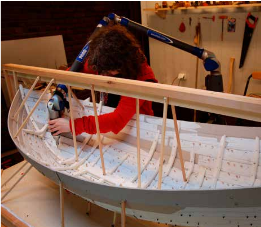
Fig. 10: Barcode 6'nın 1:5 ölçekli maketi arkeoloji personeliyle birlikte Lars Stålegård (tekne yapımcısı) ve Dr. Terje Planke tarafından yapılmıştır. Maket FARO-Arm ile kaydedilmiştir. Çizimler yapıyla dijital olarak çalışma olanağı sunmuştur ve ahşapların nasıl korunacağına karar vermede etkili olmuştur.
