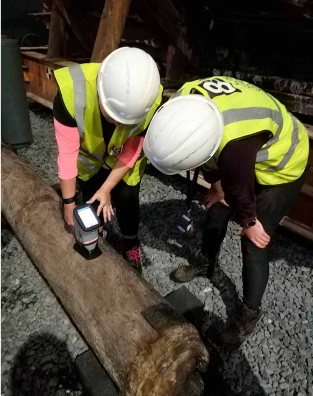
Fig. 4: Mary Rose Batığına ait ahşaplarda XRF ile gerçekleştirilen analizler.
