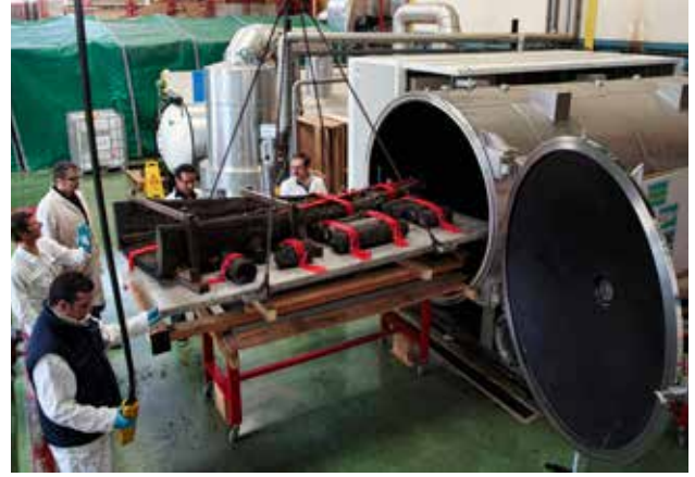
Fig. 15: Pruvanın dondurarak kurutma cihazına yerleştirilmesi. (MDAA © Rémi Bénali)
