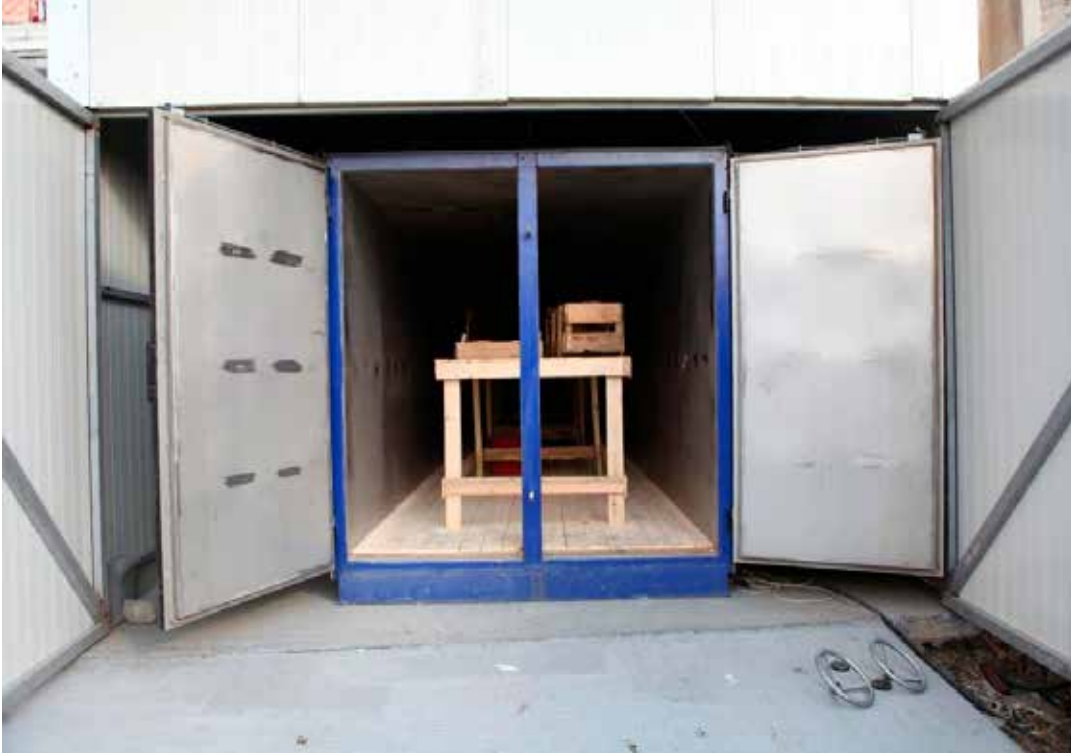
Fig. 33: Melamin formaldehit uygulamasında kullanılan fırın. Fig. 33: Oven used for melamin formaldehyde procedure.
