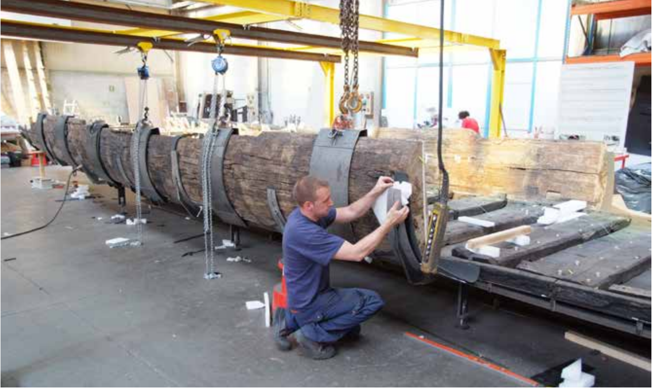
Fig. 21: Temel eğri yatay metalik plakaları destekleyen merkezi bir çelik kemereden oluşmaktadır. Diğer desteklerin her biri özel yapımdır. (© ARC-Nucléart)
