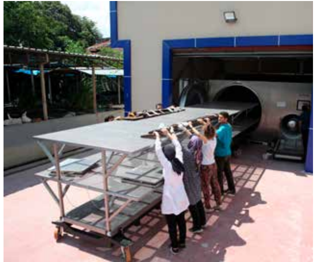
Fig. 29: Yenikapı Batıkları Projesinde kullanılan D 21/85 model vakumlu dondurarak kurutma cihazı. Fig. 29: D 21/85 model vacuum freeze dryer used in the Yenikapı Shipwrecks Project.
