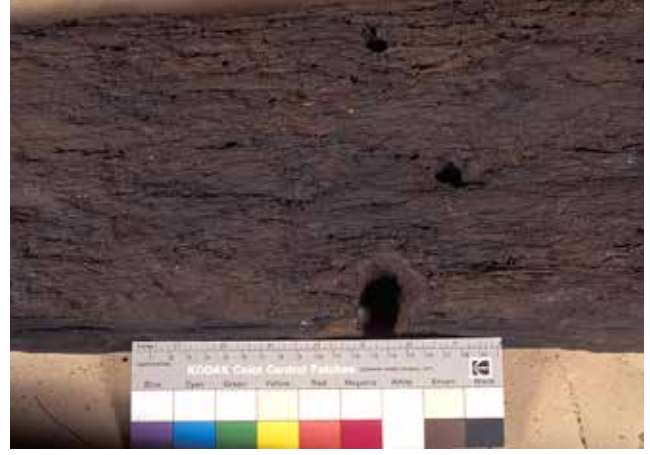
Fig. 21: PVP ile sağlamlaştırılmadan sonra asitten arındırılmış Batavia ahşabı (F0).
