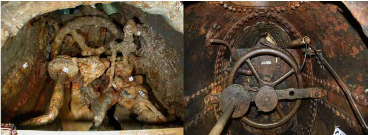
Fig. 14: Depozitlerin arındırılması sonrasında tahrik sistemi. Ortaya çıkan özellikler, dökme demir volan, bakır giriş balast borusu ve kolu, volanı hareket ettirmeye yardımcı olmak için diskli ve zincirli krank sistemi ve volanın arkasındaki direksiyon sistemidir. ©Friends of the Hunley.
